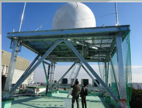
素早く雨雲をとらえる新型高速気象レーダの開発 (マルチパラメータ・フェーズドアレイレーダ)
