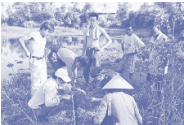
[写真6] メコンデルタにおけるハンドボーリング調査
