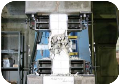
「ソフトランディング耐震補強」において、柱の破壊性状を制御することを目的とした実験
