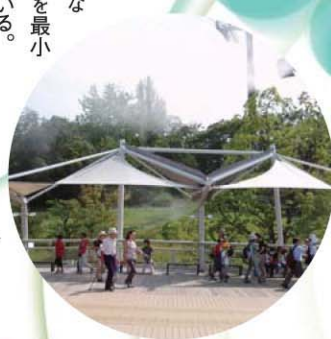
ドライミスト蒸発冷却効果によるヒートアイランド緩和
